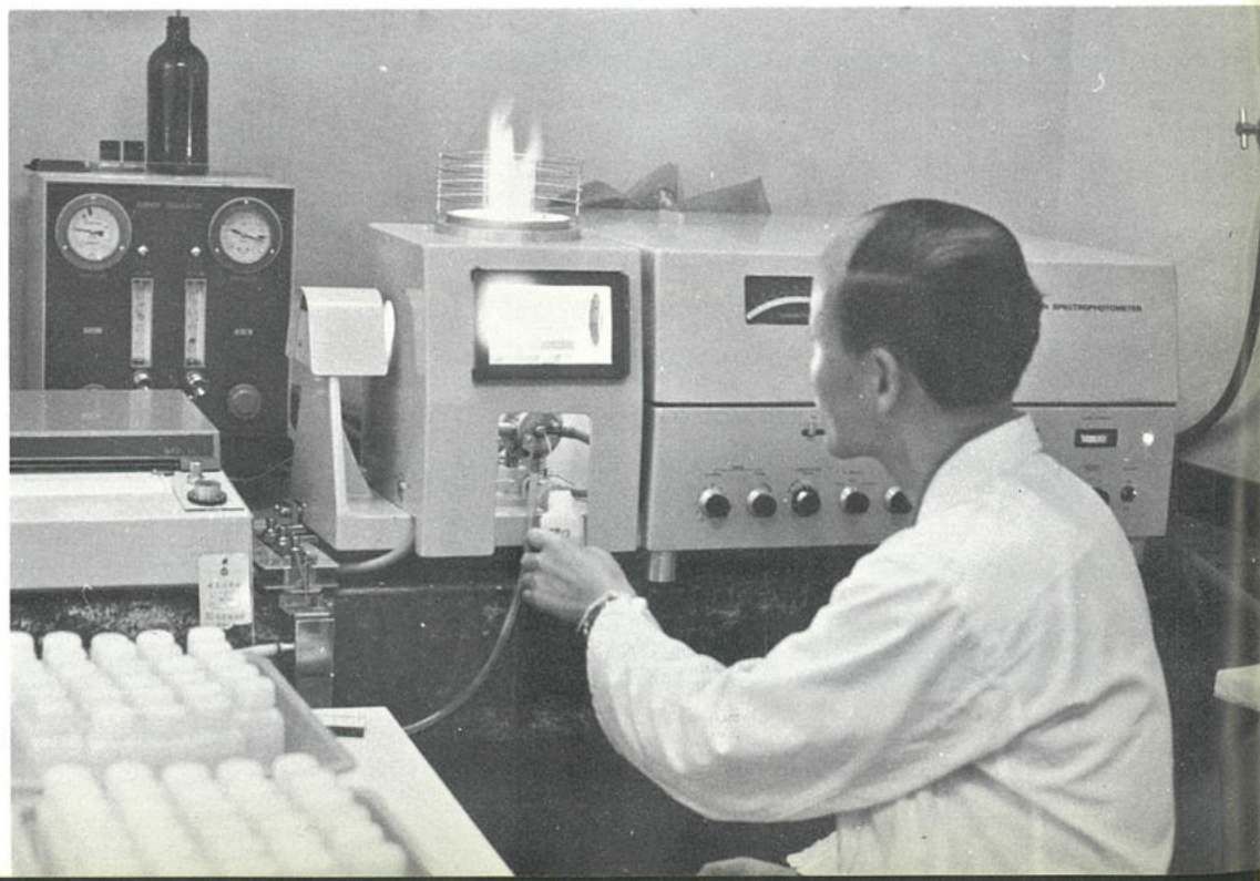
カドミウムのような液体中の金属元素等を千億分のニグラムまで正確迅速に検出できるという「原子吸光分析装置」。気体用のガスクロマトグラフと合わせ、公害等には一大威力と佐藤化学試験部長。
