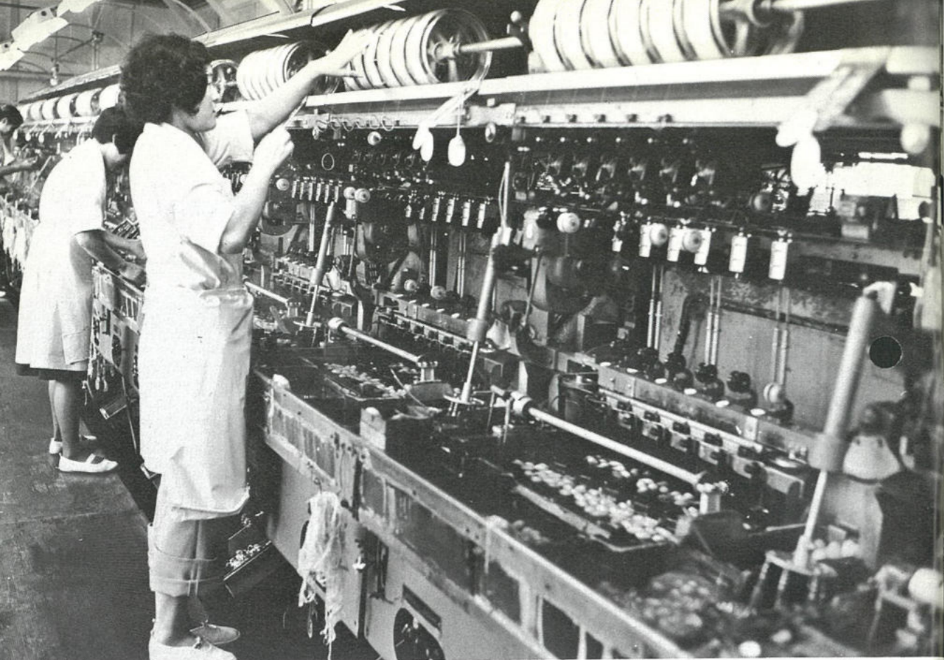
熱湯で約11分煮た繭の繭糸長（1粒の繭の平均 900～1500m）解じょ率などを調べる自動繰糸機。32台の機械がフル回転している。
