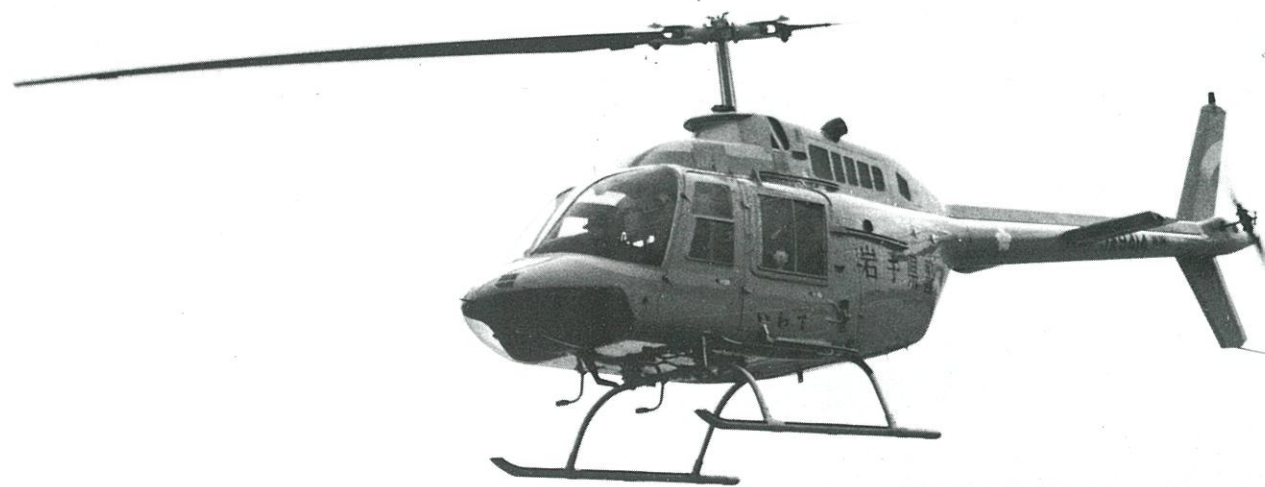
▲「いわて」の型式はベル式206B型。全長11.82 メートル 、全高3.04 メートル 、全幅1.98 メートル 、総重量約1,500 キログラム
