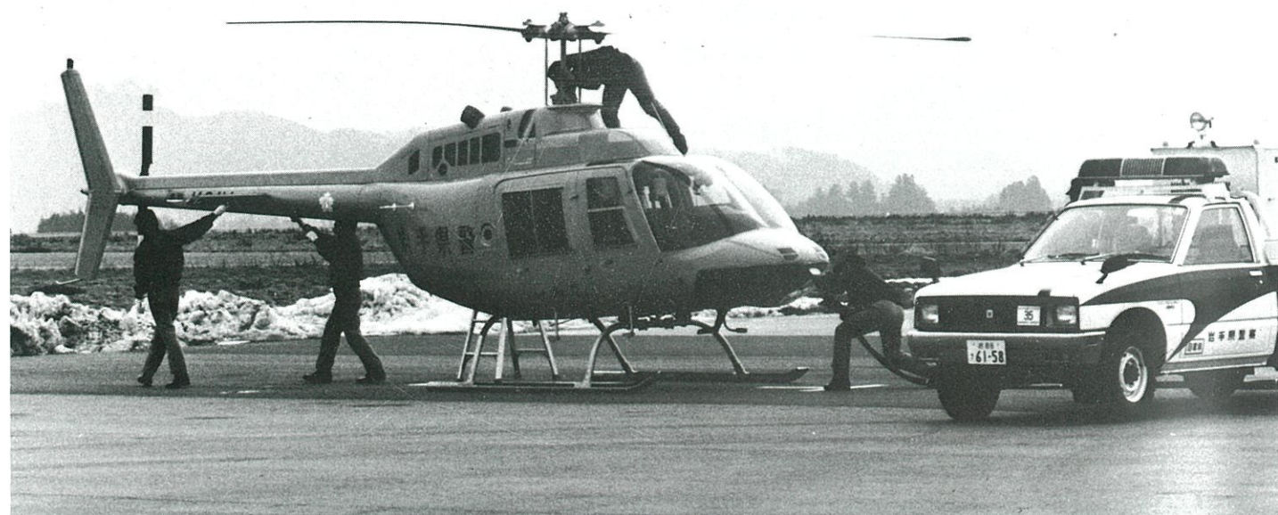
▲いよいよ発進。トラックにはヘリコプター始動用のバッテリーが装置してある
