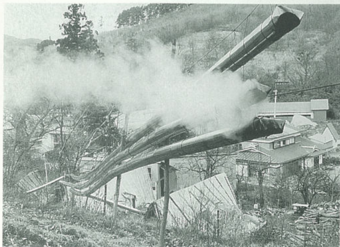
▲家に近接してかまを構えての庭先製炭が主流となっている。長い煙突は木酢液を採るための装置
