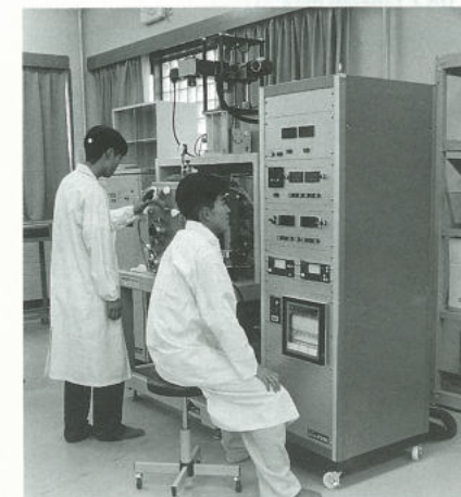
▲結晶制御・育成装置（新素材応用研究室）。さまざまな金属の単結晶を作り、その物質の基本的性質を調べるのに役立てられる
